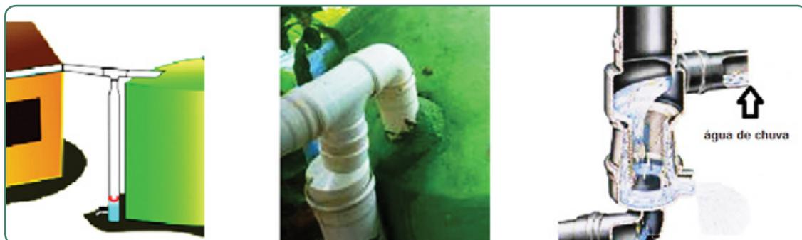
Figura 21 - Conexão entre a cisterna de armazenamento e as calhas do telhado
