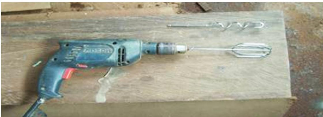
Figura 53 - Equipamento empregado para mistura da tinta.
